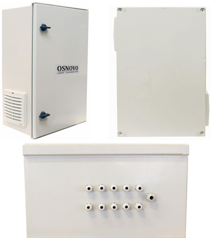
Рис. 2 Уличные станции с системой обогрева в пластиковом шкафу, проточной вентиляции и резервным питанием, внешний вид в закрытом состоянии, вид снизу панели с гермовводами, на примере модели OS-46VB1
