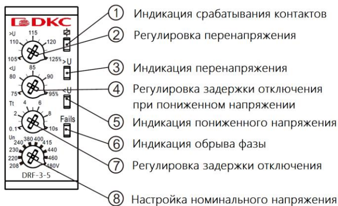
Рисунок 1 – Панель управления DRF-3-5N
