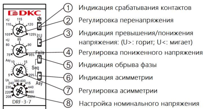
Рисунок 1 – Панель управления DRF-3-5N
