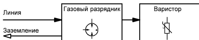
Рис. 2.8. Функционально-блочная схема ЗЛП-М всех модификаций
