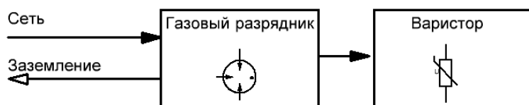
Рис. 2.2. Функционально-блочная схема УЗИП230-2
