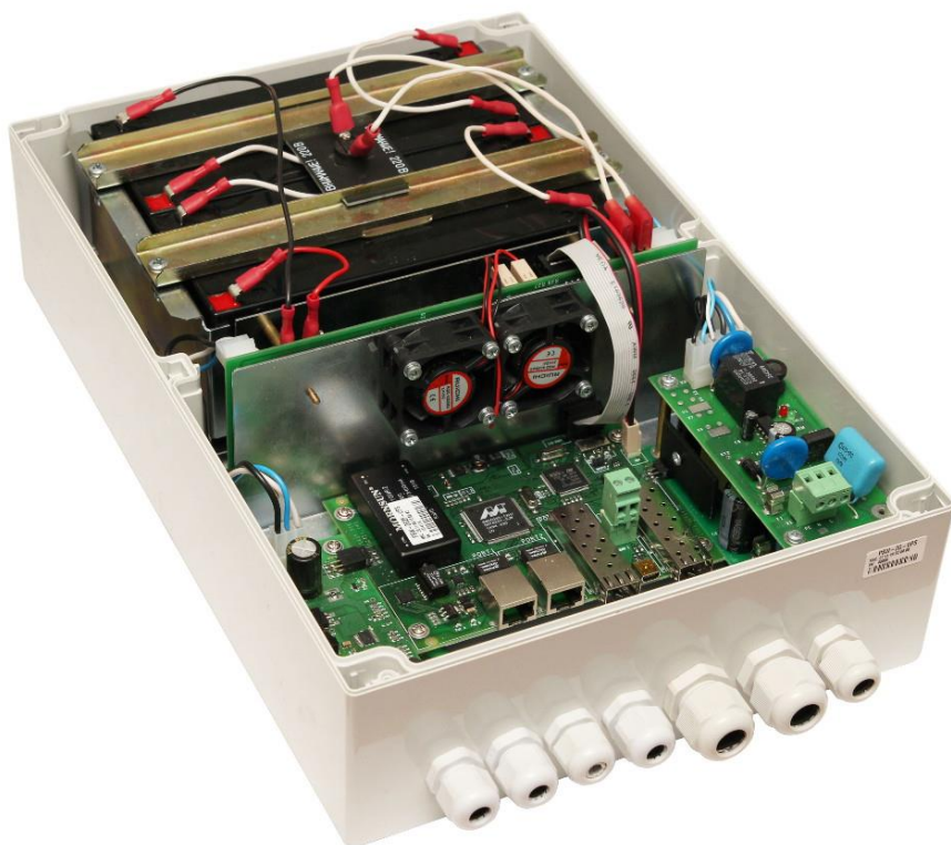
Рис. 2.1-2. PSW-2G2F+UPS - вид внутри
