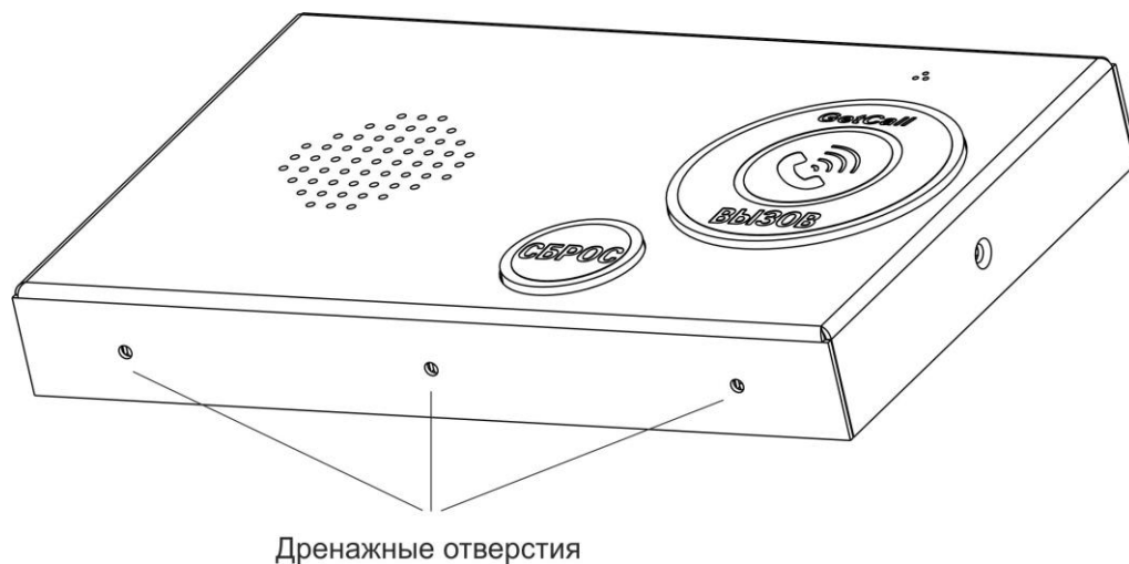
Рисунок 2. Внешний вид абонентского устройства громкой связи GC-2001B2 с дренажными отверстиями
